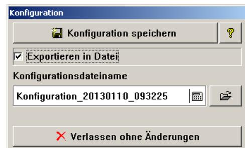
f. Dann soll die gespeicherte Konfiguration vom PC auf den Schreiber gesendet werden. Man kann es mit der Software **KD Connect** oder über die CF Karte machen. (zum Speichern der Datei auf der CF Karte kann ein Speicherkartenlesegerät verwendet werden).
