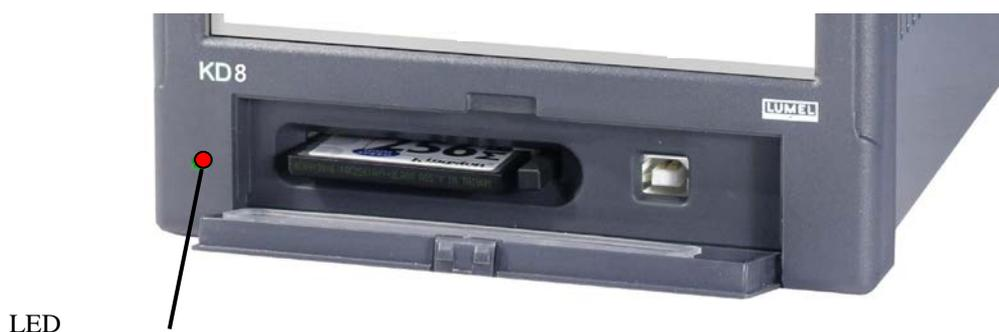
Nach Überschreitung von 90 % des Speicherplatzes auf der CF Karte (die Schaltfläche der CF Karte auf dem Display von KD8 ist rot) **wird empfohlen**, die Daten möglichst schnell von der Speicherkarte in den PC zu übertragen, die Karte zu formatieren oder durch eine andere zu ersetzen, die nicht beschrieben und formatiert wurde.
