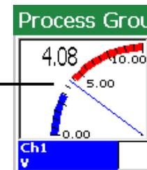
Mit blau wird auf der Analoganzeige der eingestellte Alarmbereich des Types Min, mit rot der eingestellte Alarmbereich des Types Max.
